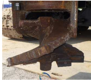
逆テーパ型先端スクリュー構造
