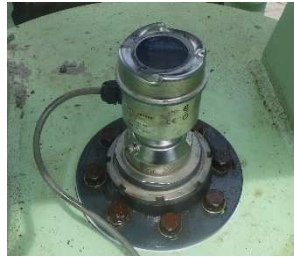
砂面計測用マイクロウェーブ式レベル計
